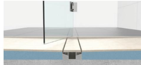
Durch den zur Wand abfallenden Boden wird das Spritzwasser am Türflügel direkt in die Duschrinne geleitet.
