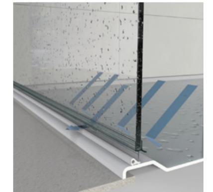
Mit Dichtprofil und Schallschutz – Kaum Wasser kann nach außen dringen
