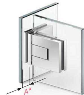
Beim Beschlag Glas-Glas 90° sind nur Glasbohrungen im Seitenteil nötig, dadurch ist ein Einrücken des Glastürflügels nach innen möglich und der Überstand (\*A) kann selbst bestimmt werden.
