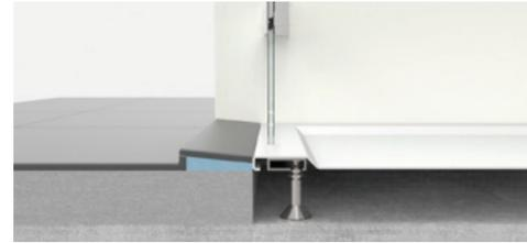
Durch die vorgesetzte keilförmige Verfließung besteht die Möglichkeit, ohne untere Dichtung zu verbauen. Je nach Beanspruchungsklasse muss hierbei die richtige Feuchtraumabdichtung nach den anerkannten Richtlinien ausgeführt werden.
